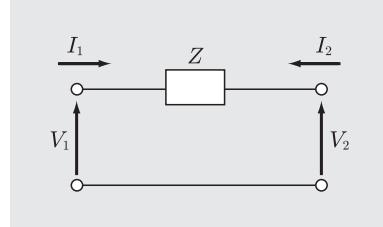
$$\begin{cases} I_1 = -I_2 \\ V_1 = I_1 Z + V_2 \end{cases} \implies \begin{cases} I_1 = \frac{1}{Z}(V_1 - V_2) \\ I_2 = -\frac{1}{Z}(V_1 - V_2) \end{cases}$$
