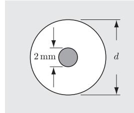
□ 6 図 3.34, 図 3.33 より  $\frac{a}{b} = 3$  の  $Z_0$  と  $\sqrt{\epsilon_{\text{eff}}}$  を求めると、各々、 $70 \Omega$  と  $2.5$ 。よって特性インピーダンスは  $\frac{70}{2.5} = 30 [\Omega]$ .
