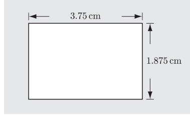
(2)  $\frac{4+8}{2} = 6$  GHz での管内波長  $\lambda_g$ 、特性インピーダンス  $Z_0$ 、群速度  $v_g$  を求める。
